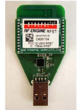
SN132 SNAPstick USB module
