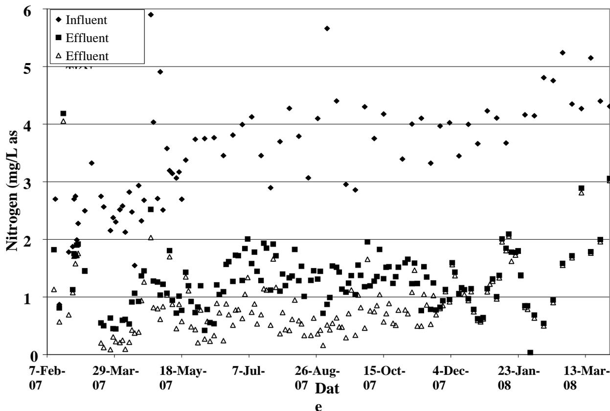
Figure 6. CWRP Influent and Effluent TN and Effluent TKN.
