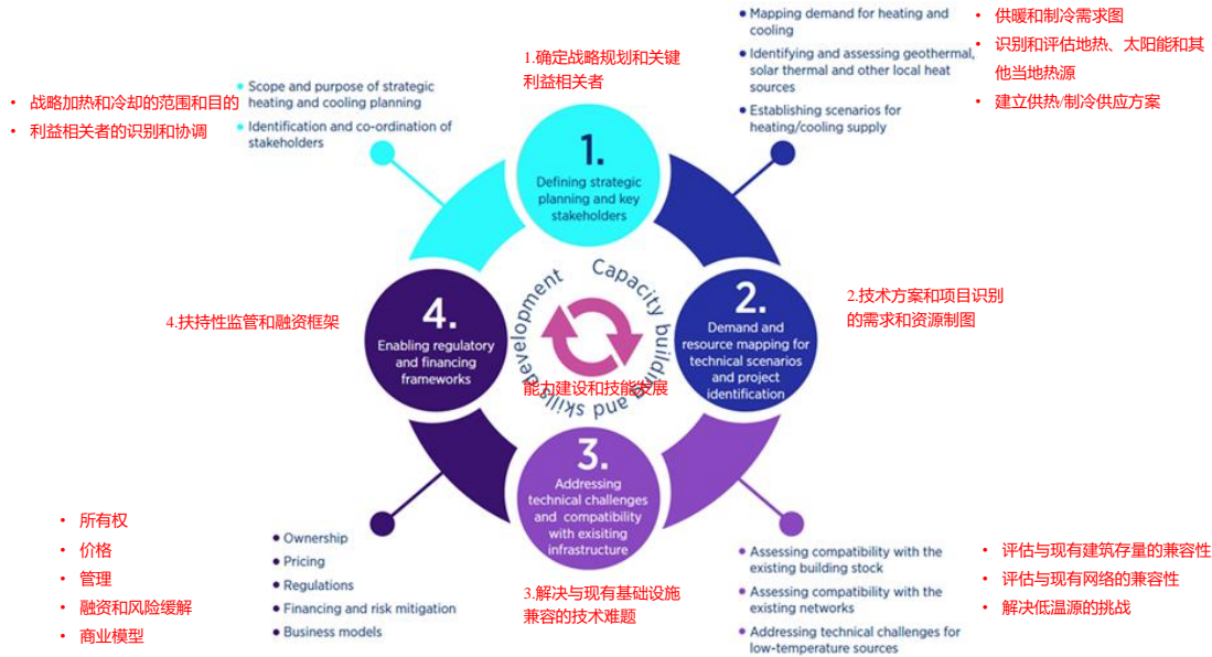
图 14.11 将低温源集成到 DES 的框架示意图(Bertelsen et al., 2021)
