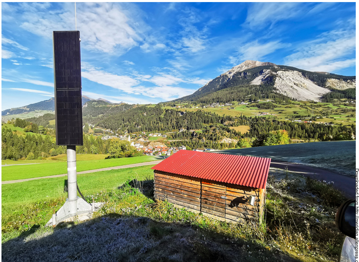
Eine permanente Radarüberwachung ist heutzutage in einer grossen Risikosituation wie der Rutschung in Brienz/Brinzauls unabdingbar. / De nos jours, une surveillance radar permanente est indispensable dans une situation de risque majeur comme le glissement de terrain de Brienz/Brinzauls.
