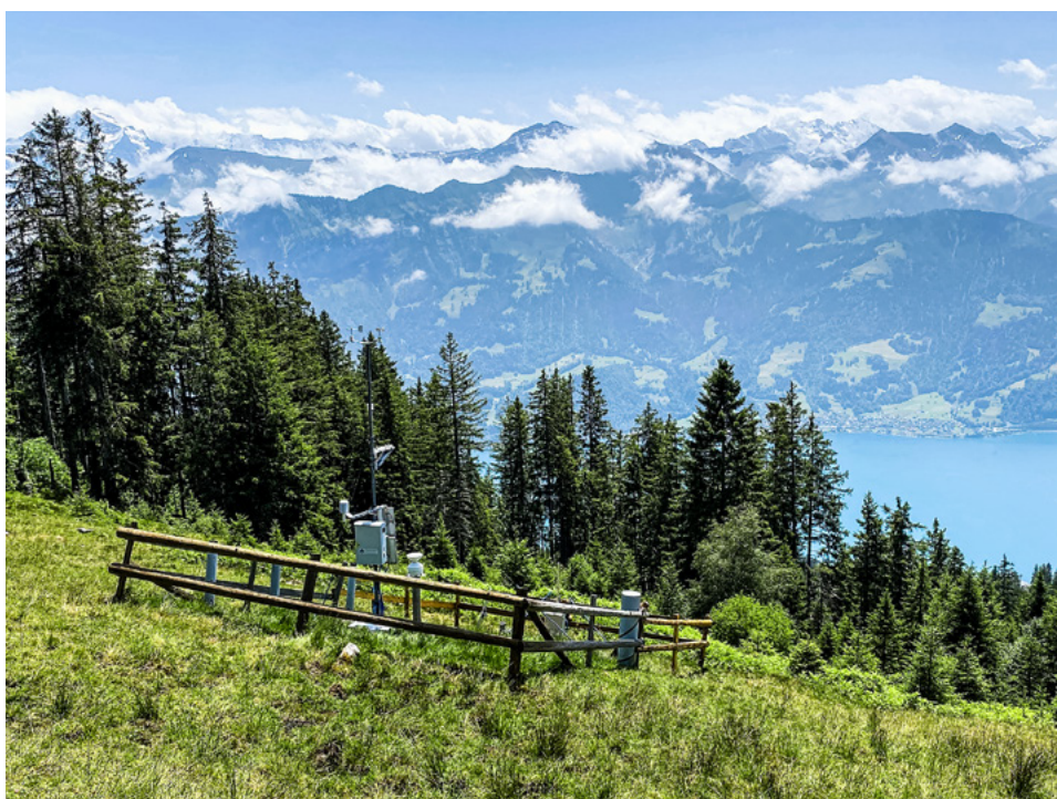
Abb 1 Die Meteostation am LWF-Standort Beatenberg (BEA) ist mit Sensoren für Temperatur-, Luftfeuchtigkeits-, Niederschlags-, Wind- und Strahlungsmessungen ausgestattet. Foto: Matthias Haeni
