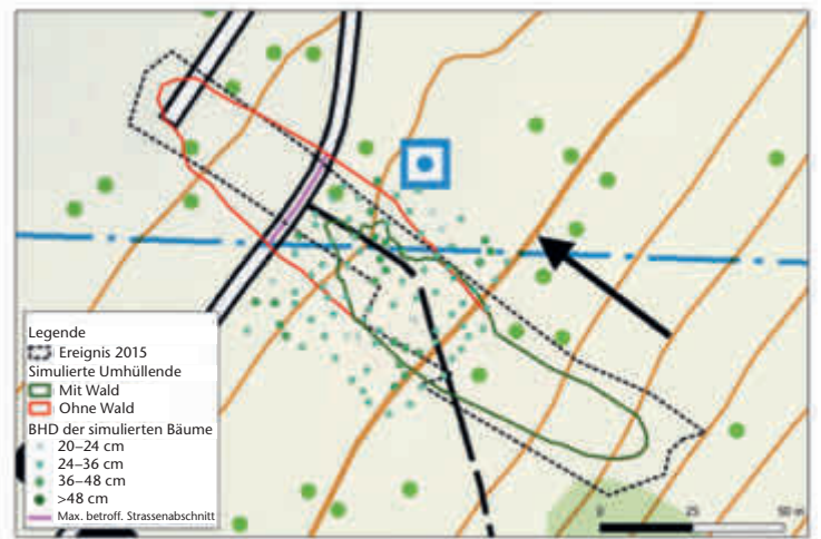
Abb 8 Übereinstimmung zwischen der StorMe-ereignisumhüllenden (schwarz gestrichelte Linie) und der simulierten Auslaufläche der besten Parameterinstellungen, sowohl für die Simulationen mit (grüne Linie) als auch ohne Wald (rote Linie). Der Hang verläuft in Richtung des schwarzen Pfeils. Karte: swisstopo
