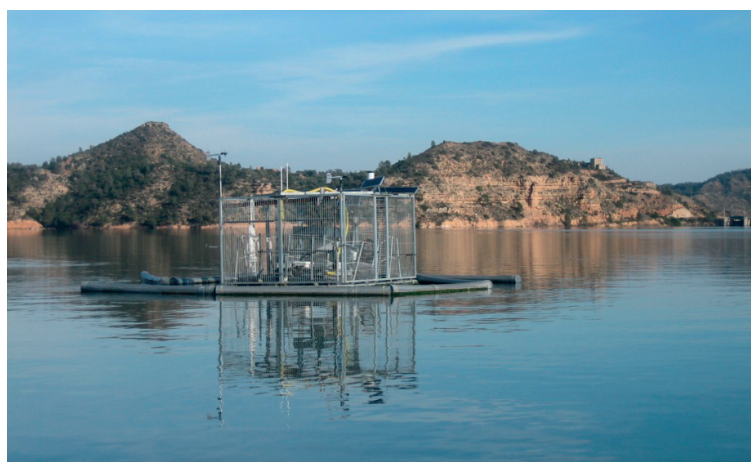
Figura 1 | Plataforma de medida automatizada instalada en el embalse de Riba-roja por Flumen en los años 2007-2010. La plataforma flotante estaba equipada con una estación meteorológica y una sonda multiparamétrica. La sonda medía la temperatura del agua, conductividad, concentración de oxígeno y velocidad del agua cada seis horas y a diferentes profundidades.
