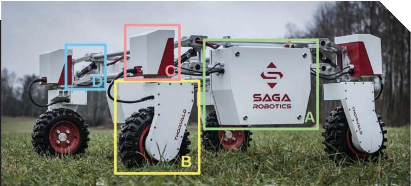
**FIGURE 2** Thorvald modules. A) Battery enclosure module, B) drive module, C) steering module, D) suspension module.
