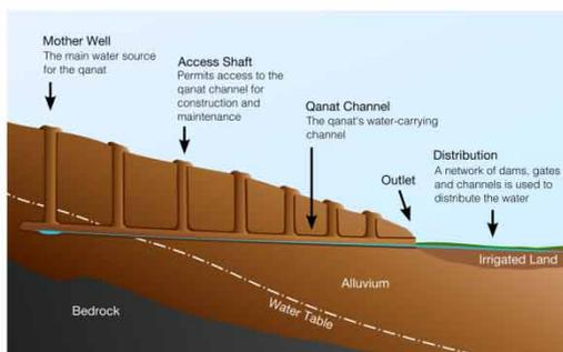
Fig.4: lo schema di funzionamento di una *khattara*
