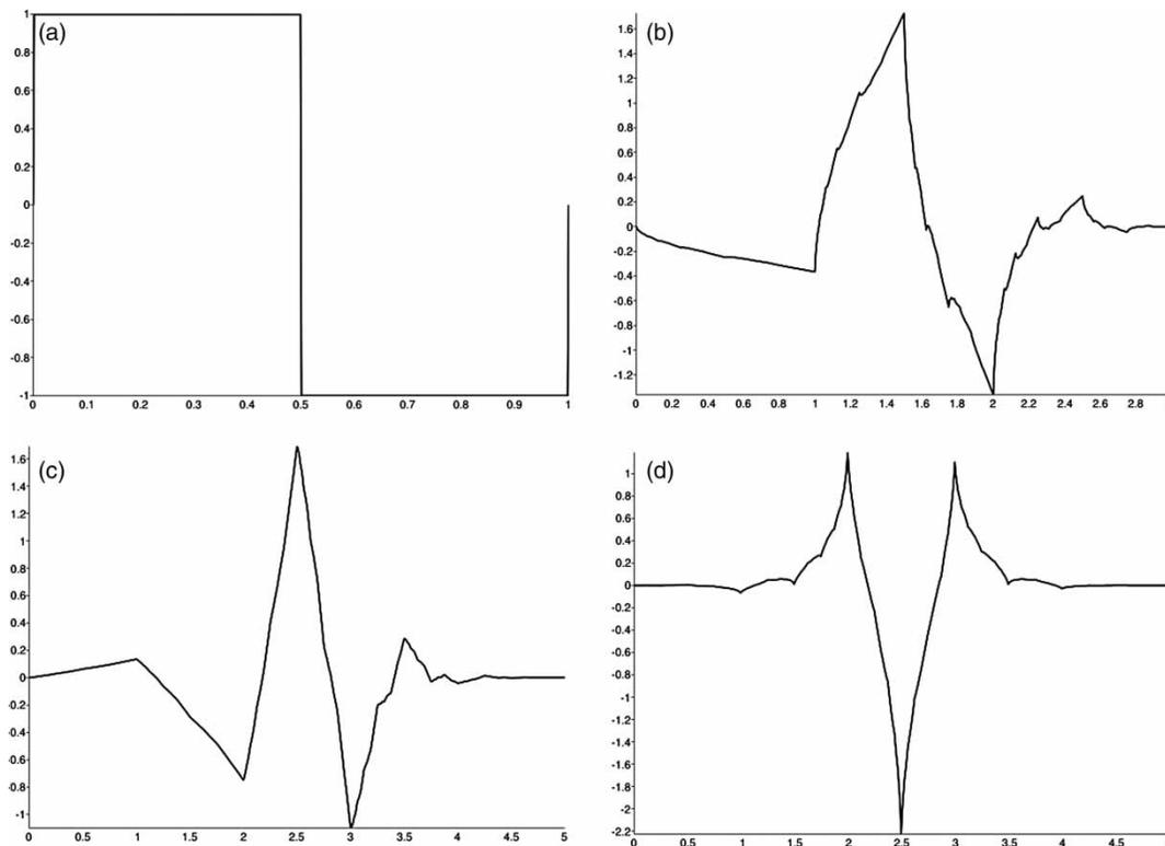
Figure 3 | (a) Haar wavelet, (b) db2 wavelet, (c) sym3 wavelet and (d) coif1 wavelet.
