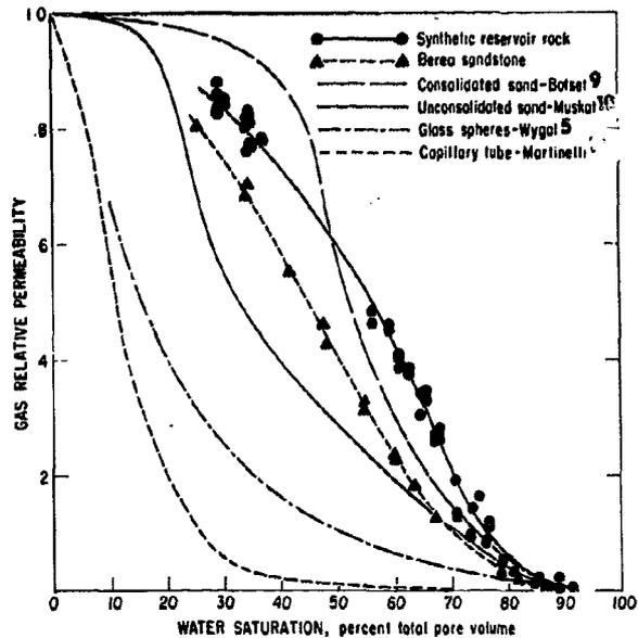
FIG. 2 — GAS RELATIVE PERMEABILITY CURVES, DRAINAGE.
