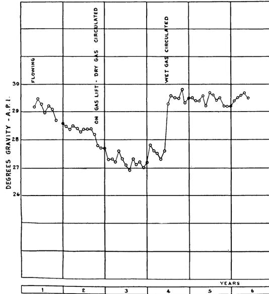
FIG. 3.—EFFECT OF SUBSTITUTING WET GAS CIRCULATION FOR DRY GAS IN GAS-LIFT OPERATIONS.
