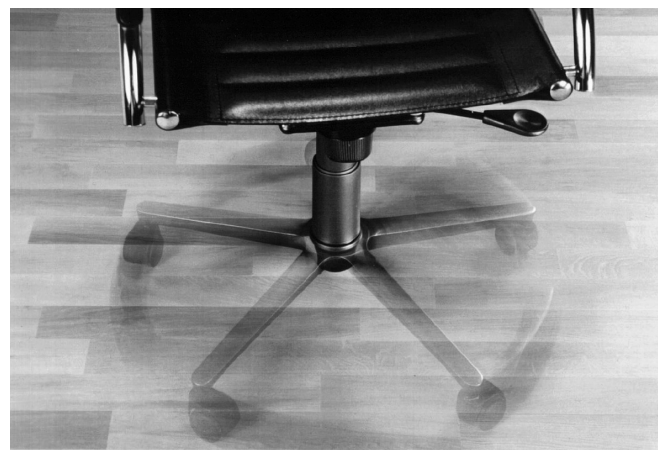
Abbildung 1: Charakterisierung der Verschleisseigenschaften mittels Stuhlrollentest (Foto: Bauwerk AG).
