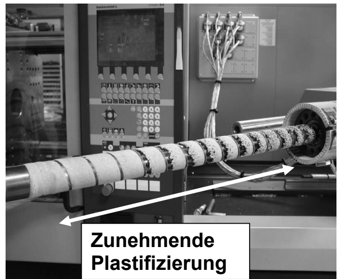
Abbildung 3: Zunehmende Plastifizierung des Compounds an einer Schnecke im Spritzgussprozess (Quelle: Battenfeld).
