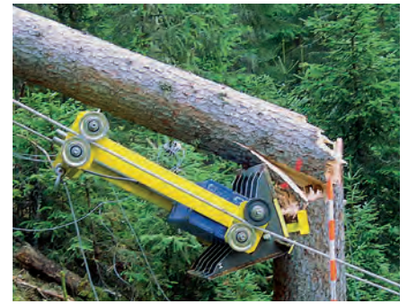
Abb 4 Anprallversuch. Auf den zwei Führungsseilen frei fahrender Anprallwagen unmittelbar nach dem Test. Der 517 kg schwere Anprallwagen prallte mit einer Geschwindigkeit von 21,4 m/s auf den Testbaum mit einem Durchmesser d_{1.3} = 43 cm. Die Energie von 118 kJ reichte aus, um den Baum zu brechen. Dank dieses realitätsnahen dynamischen Tests kann das Energieabsorptionsvermögen von Bäumen bei Steinschlag berechnet werden.
