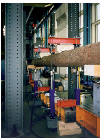
Abb 2 Vier-Punkt-Biegeversuch am frischen Baumstamm.
