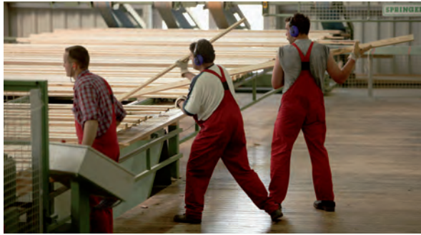
Abb 6 Sortierung von Schnittholz im Grosssägewerk.
