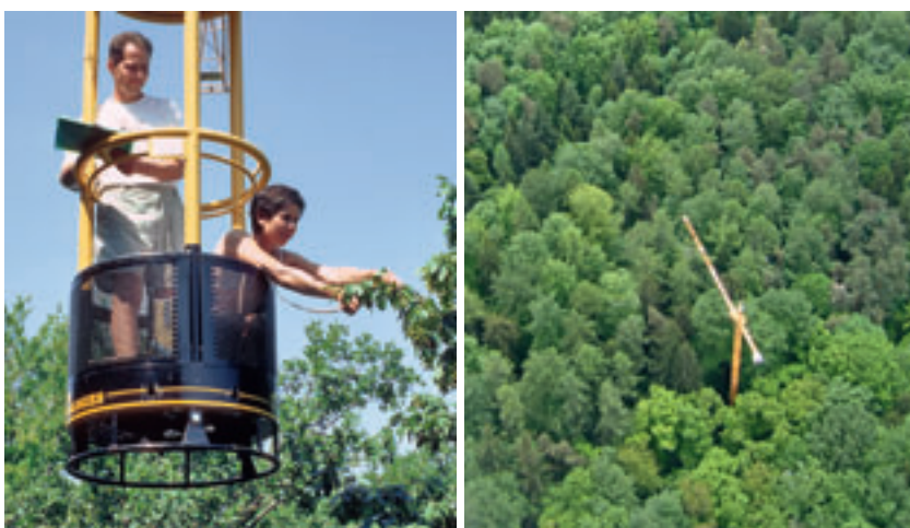
Abb 4 Das FACE-Forschungsprojekt in Hofstetten (SO). Manipulative Experimente mit adulten Waldbäumen stellen erhebliche Ansprüche an die Logistik. Links: Blattleitfähigkeitsmessungen von der Krangon aus. Rechts: der Forschungskran aus der Luft.
