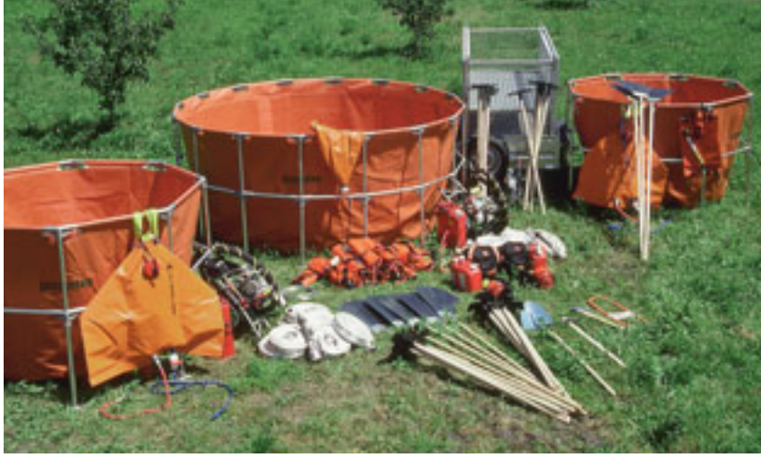
Abb 7 Das mobile Feuerbekämpfungsmaterial kann im Ernstfall mit einem Helikopter oder einem Fahrzeug zum Brandort transportiert werden.
