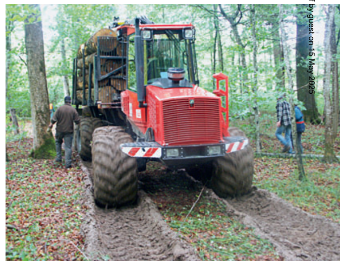
Abb 2 Fahrversuche in Ermatingen (Kanton Thurgau): Durch das gezielte Anlegen von Fahrspuren in einem kontinuierlich ansteigenden Bodenfeuchtegradienten konnte eine stetig zunehmende Deformation der Bodenstruktur erzeugt werden.
