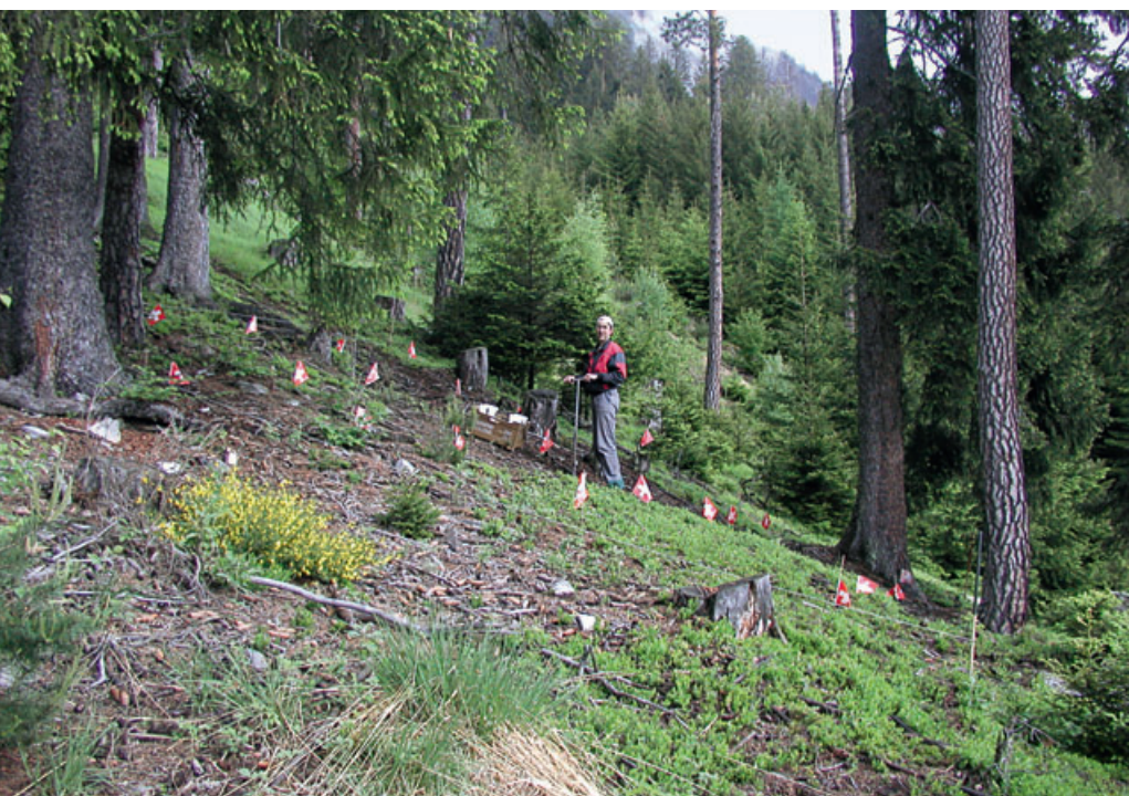
Abb 2 Probenahme der Flächenmischprobe 0–20 cm am Standort 90, Sta Maria GR (links). Probenahmeplan zur Entnahme von 4 Mischproben aus je 25 Einstichen (rechts).
