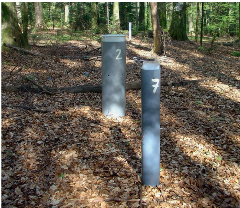
Fig. 2 Collecteurs de pluie et de neige à Lausanne.
