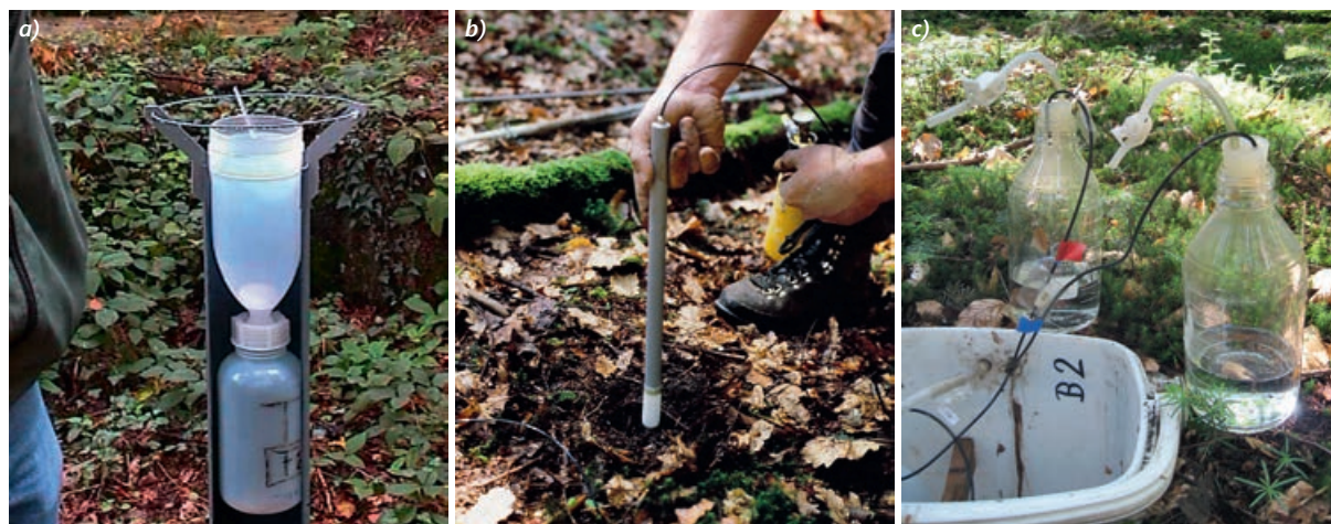
Fig. 3 Collecteur de pluie (a), installation d'un lysimètre sous-tension avec bougie en céramique (b) et échantillons de solution du sol (c).
