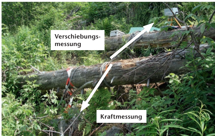
Abb 2 Zugversuche in der Windwurffläche Uaul Cavorgia bei Disentis. Foto: Peter Bebi
