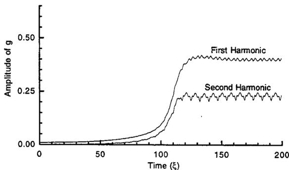
FIG.6 THE TIME HISTORY OF THE AMPLITUDES OF THE DISTURBANCE AXIAL VELOCITY COEFFICIENT FOR THE SAME CASE AS FIG.5
