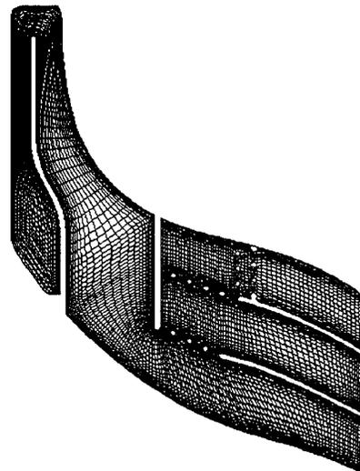
FIGURE 3: COOLING PASSAGE GRID
