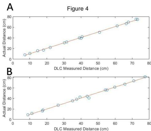
**FIGURE 4:** (A) SHOWS THE RIGHT FOOT DLC MEASURED DISTANCES VS THE ACTUAL DISTANCE ALONGSIDE THE LINEAR REGRESSION. (B) SHOWS THE LEFT FOOT DLC MEASURED DISTANCES VS THE ACTUAL DISTANCE ALONGSIDE THE LINEAR REGRESSION.
