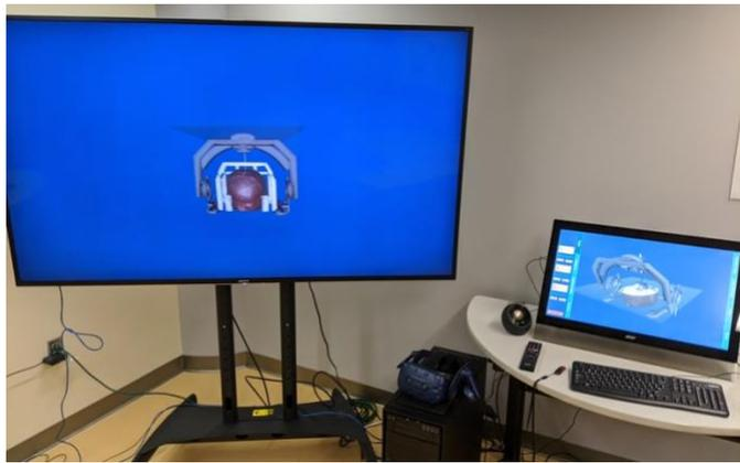
**FIGURE 3:** THE FIRST VIRTUAL REALITY TOOL DESIGN FOR DEEP BRAIN STIMULATION PROCEDURAL PLANNING USING A STEREOSCOPIC DISPLAY (LEFT) AND TOUCH SCREEN (RIGHT).
