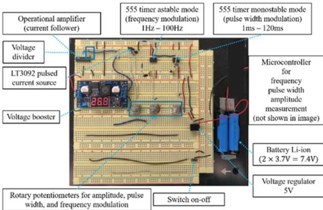
**FIGURE 3: MECHATRONIC EUCD PROTOTYPED ON A SOLDERLESS BREADBOARD**
