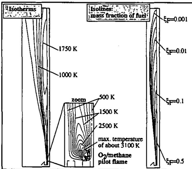
FIG. 11:  $O_2$ -STABILIZED BURNER: STEADY-STATE CALCULATION
