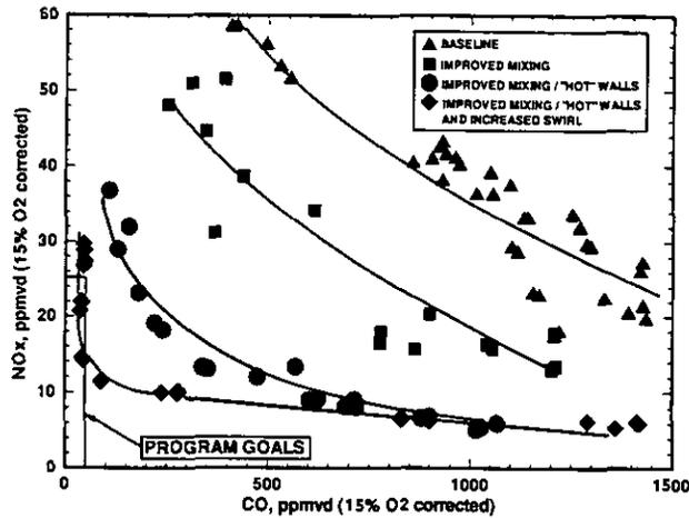
FIGURE 17. EFFECT OF FUEL/AIR MIXING EFFICIENCY AND WALL COOLING ON  $NO_x$  VS. CO TRADEOFF.
