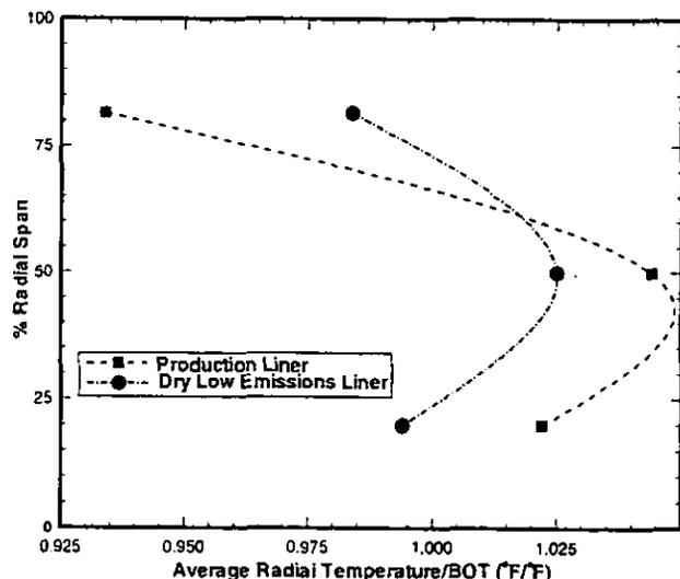
FIGURE 19. COMPARISON OF MEASURED RADIAL TEMPERATURE PROFILE BETWEEN PRODUCTION LINER AND DRY LOW  $NO_x$  CONFIGURATION 2.
