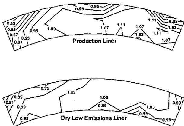
FIGURE 18. COMPARISON OF MEASURED COMBUSTOR EXIT TEMPERATURE DISTRIBUTION BETWEEN PRODUCTION LINER AND DRY LOW  $NO_x$  CONFIGURATION 2.
