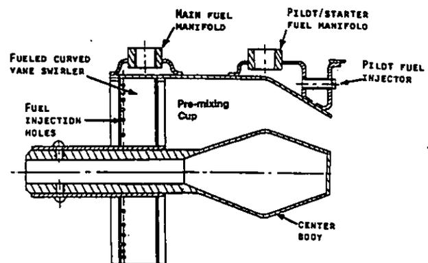
FIGURE 2. LEAN PRE-MIX DOME FOR DRY LOW  $NO_x$  CONFIGURATION 2.
