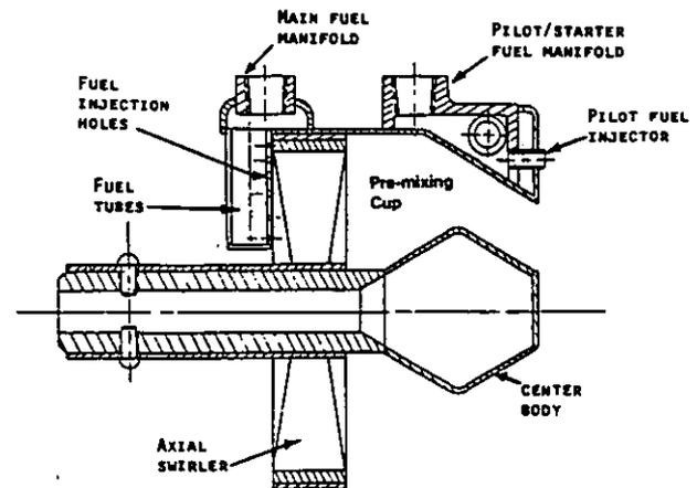
FIGURE 1. LEAN PRE-MIX DOME FOR DRY LOW  $NO_x$  CONFIGURATION 1.
