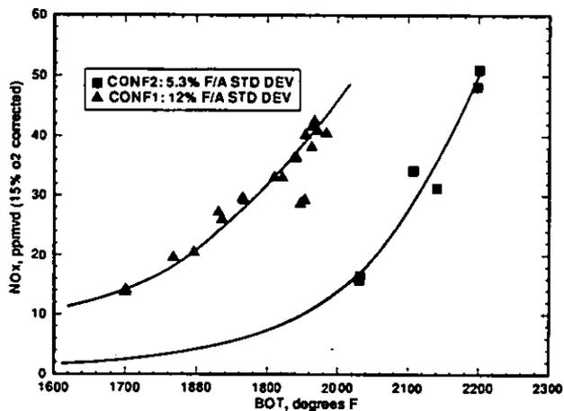
FIGURE 16. EFFECT OF FUEL/AIR MIXING EFFICIENCY ON NO<sub>x</sub> EMISSIONS.
