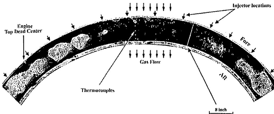
FIG. 5 - THE INNER SURFACE OF THE HI-NICALON/SiC OUTER LINER AFTER 2258 HOURS EXPOSURE TO THE COMBUSTION ENVIRONMENT
