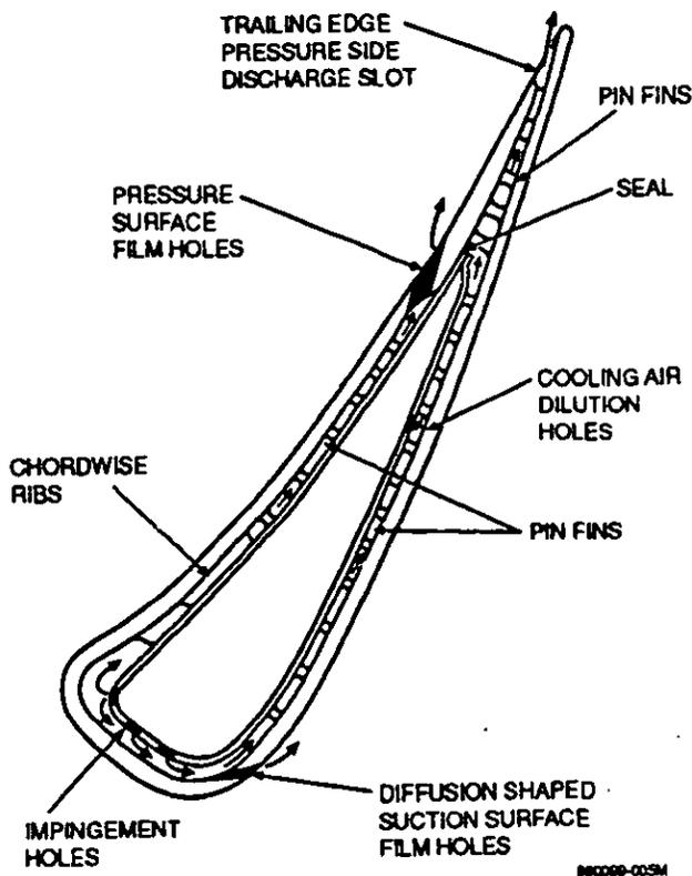
FIG. 3 - VANE AIRFOIL COOLING CONFIGURATION
