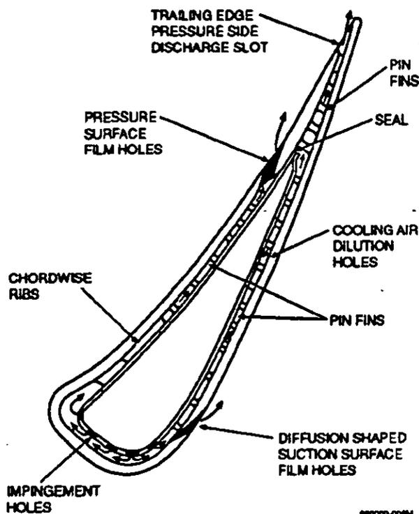
FIG. 14 - TUNED VANE AIRFOIL COOLING CONFIGURATION
