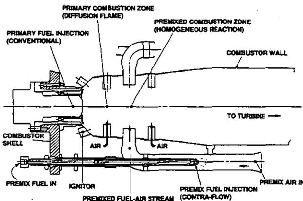
FIG. 19. HYBRID BURNER
