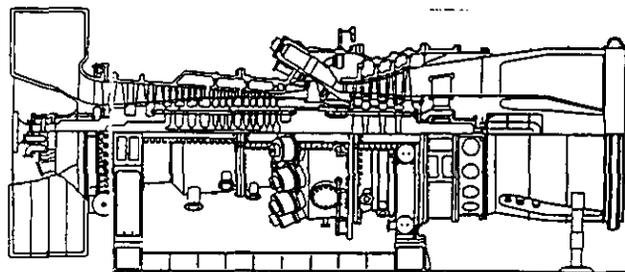
FIG. 9. GENERAL CONFIGURATION OF 501F COMBUSTION TURBINE
