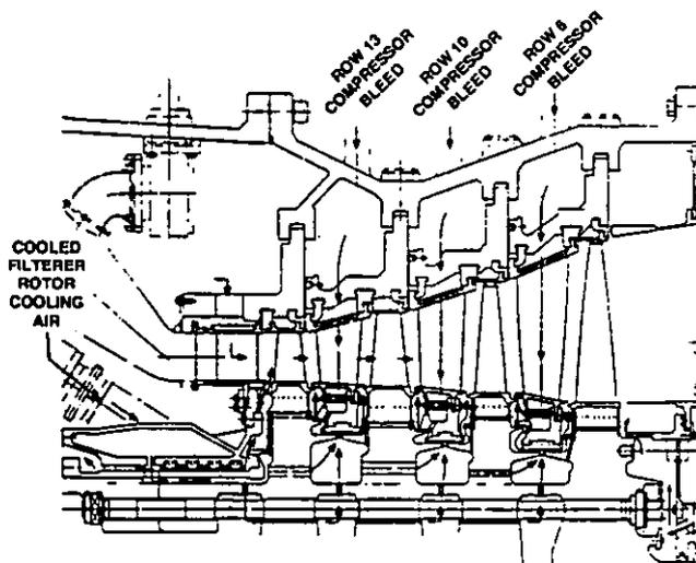
FIG. 10. COOLING CIRCUITS FOR THE 501F COMBUSTION TURBINE
