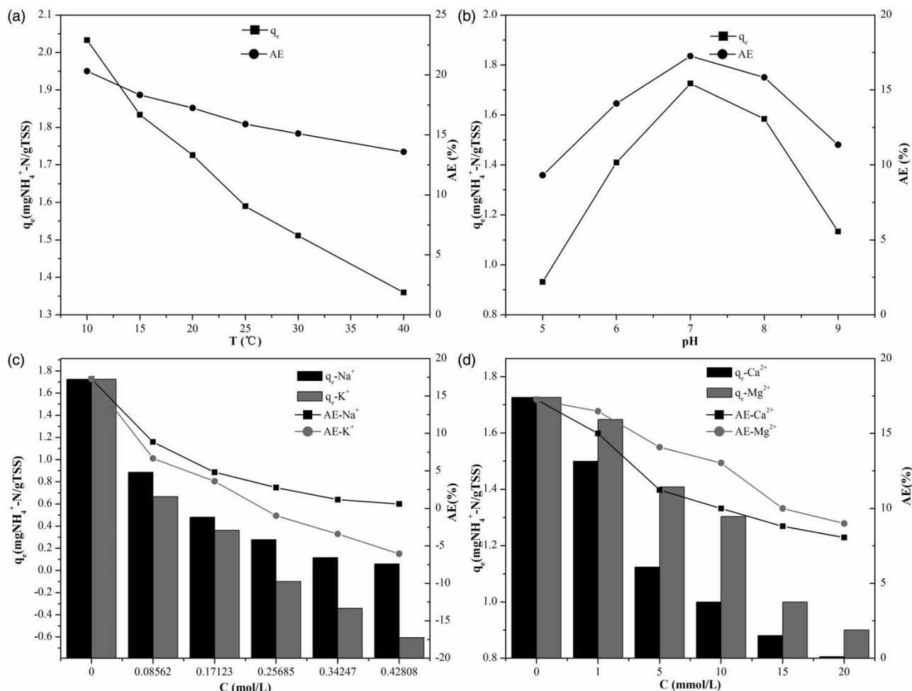
Figure 4 | The effect of (a) temperature, (b) pH, (c) K<sup>+</sup> and Na<sup>+</sup> and (d) Ca<sup>2+</sup> and Mg<sup>2+</sup> on ammonium adsorption.
