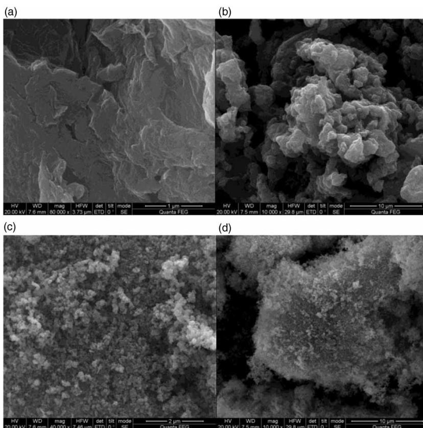
**Figure 1** | SEM photographs of (a) GO, (b) NGO, (c) Fe<sub>3</sub>O<sub>4</sub>, (d) NGO-Fe<sub>3</sub>O<sub>4</sub>.
